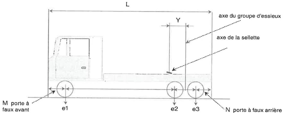
Dimensions en millimètres, masses en kg, essieux numérotés de l'avant vers l'arrière
